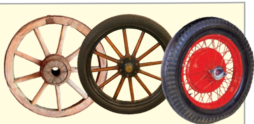
● Točkovi s paocima. Žičani točak konstruisan je početkom XIX veka. Bio je dovoljno lagan i pouzdan za upotrebu na biciklu, a korišćen je i za prve automobile
